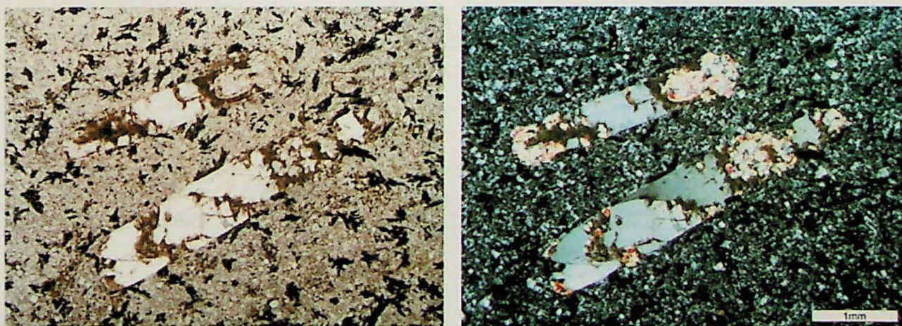
Fotomicrografia 2 - Amostra P-36. Fenocristais de feldspato potássico com porções alteradas. Observam-se os pequenos agregados de clinopiroxênio e anfibólio na matriz. Nicóis paralelos (esquerda) e cruzados (direita).
