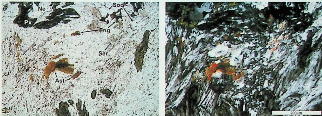
Fotomicrografia 9 - Fonolito africano, amostra P-23B. Agregado de cristais fibrosos de astrofilita. Observe-se, também, enigmatita e sodalita intersticiais, e agregados de serandita e clinopiroxênio. Px, clinopiroxênio; Ne, nefelina; Eng, enigmatita; Ser, serandita; Ast, astrofilita; Sod, sodalita. Nicóis paralelos (esquerda) e cruzados (direita).
