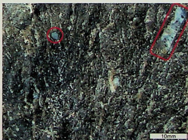
Foto 3 - Fonolito porfirítico - Amostra P-36. Em destaque, fenocristais idiomórficos de nefelina e feldspato potássico.
