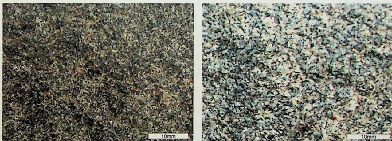
Foto 4 - Fonolito afírico. Amostra P-02B (esquerda): variedade com granulação muito fina e brilho gorduroso. Amostra P-16B (direita): variedade com granulação fina, com visíveis prismas de clinopiroxênio.
